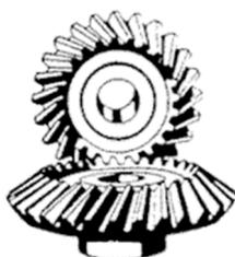
Les deux axes de rotation sont concourants et le plus souvent orthogonaux.
