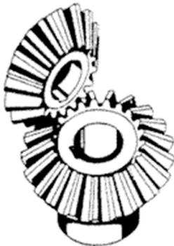
Les deux axes de rotation sont concourants et le plus souvent orthogonaux.
