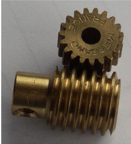
L'une des deux roues est remplacée par une vis sans fin.
